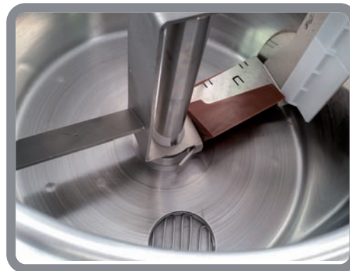
Agitatore con lama raschiante in polietilene (pe) a lunga durata. tutte le parti a contatto con la miscela o il gelato sono in acciaio inox e in materiale atossico facilmente accessibili e smontabili per la pulizia. Long-duration stirrer with rasp blade in polyethylene. all parts in contacts with the mix or ice-cream are in stainless steel and in nontoxic material; all are easily accessible and removable for cleaning.
